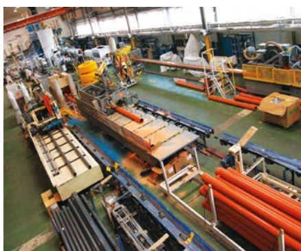
Linia technologiczna PVC-U
